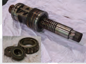
ベアリング ボールねじ交換
